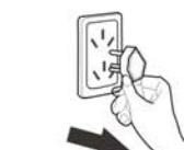
拔下电源插头时,须拿住插头拔出,不要用力猛拉或扭曲电源线。若电源线损坏后,请使用本公司提供的专用电源线来更换。
