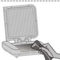
放油过多溢出时,请及时擦拭,切忌让油污流入产品内部,以免影响电饼铛(多功能煎烤机)的正常工作。
